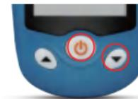
Pulse ⌂ el botón 3 segundos para apagar el medidor.
