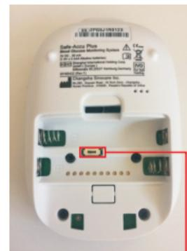
Die Safe AQ Voice ist als "Voice On" voreingestellt. Schieben Sie den Batteriefachdeckel vom Messgerät. Nehmen Sie die Batterien heraus. Der Sprachschalter befindet sich im Batteriekammer. Schieben Sie den Voice-Schalter auf die "ON" Seite. Die Voice wird eingeschaltet und auf dem Bildschirm wird das Symbol "♪" angezeigt, wenn das Messgerät eingeschaltet ist. Wenn Sie auf die "OFF" Seite schieben, wird die Stimme ausgeschaltet und auf dem Bildschirm wird kein "♪" Zeichen angezeigt.
