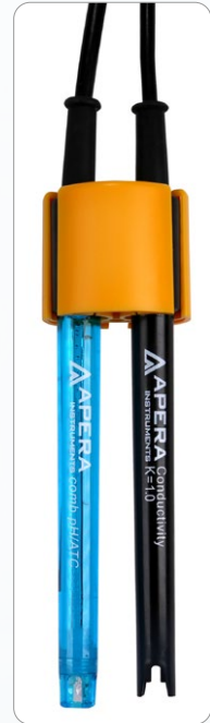
複数のセンサ同士をひとまとめ 電極コンボホルダー
