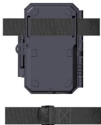
Abbildung 18: Montage der Kamera
