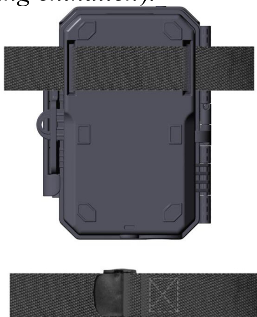
Abb. 12: Montage der Kamera
