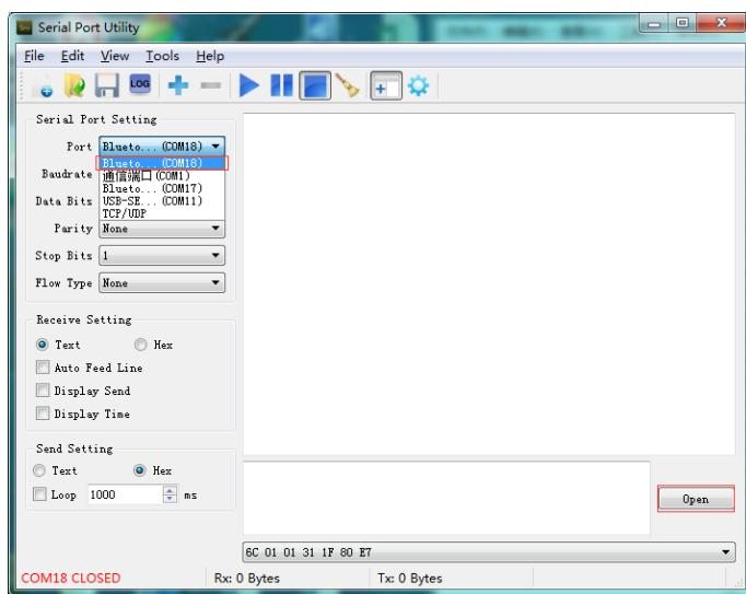
接続が完了した後、次のように読み取ったバーコードがシリアルデバッグツールに表示されます。
