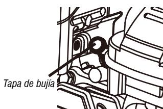
4. Al instalar una nueva bujía, ajuste la separación de la bujía a la especificación en la tabla de Especificaciones. No haga palanca contra el electrodo, la bujía puede dañarse.
