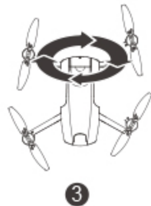
3 Halten Sie die Drohne senkrecht und drehen Sie sie einige Male um 360 Grad. Die Anzeige blinkt von schnell bis konstant.
