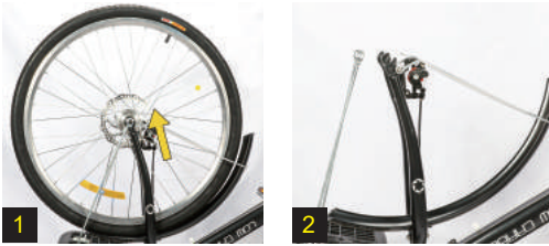
Figure 1, 2: Démontez la roue avant du vélo d'origine
