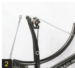
Foto 1,2: saca la rueda delantera de la bicicleta original
