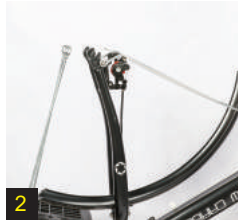
Bild 1,2: Demontieren Sie das originale Frontrad.
