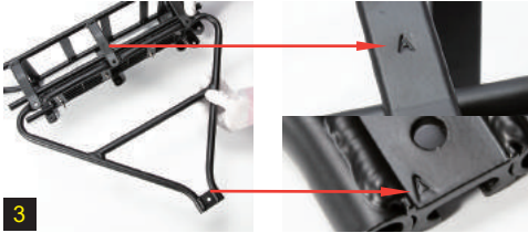
Figure 3,4 : Installez la structure du porte-bagages(Remarque : trouvez la position d'installation correcte à travers la surface A marquée sur le porte-bagages)
