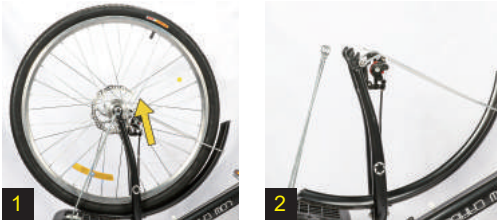
Figure 1, 2: Démontez la roue avant du vélo d'origine
