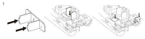
Glue the frame, VTX mount and Motor mount. 将机身框架木片和图传固定的木片粘贴到机身上。
