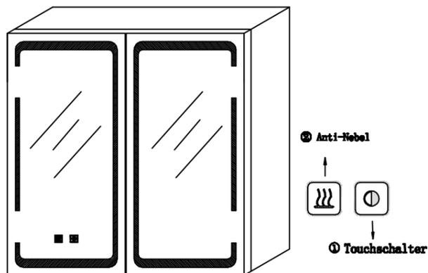
Schließlich wird der Stromkreis eingeschaltet und der Touchschalter (Bild 1) auf der Linse wird mit einem Finger berührt, um das Produkt zu testen.
