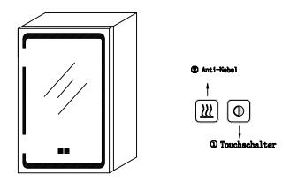
Schließlich wird der Stromkreis eingeschaltet und der Touchchalter (Bild 1) auf der Linse wird mit einem Finger berührt, um das Produk zu testen.
