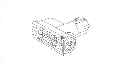
③ 「ローラーブラシ」の先端を持ち上げて外します。
