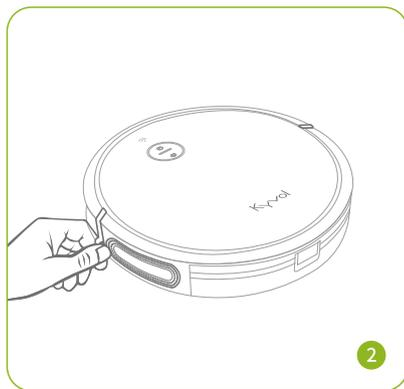
「サイドブラシ」をロボット掃除機底面の「サイドブラシ取付溝」に取り付けます。
