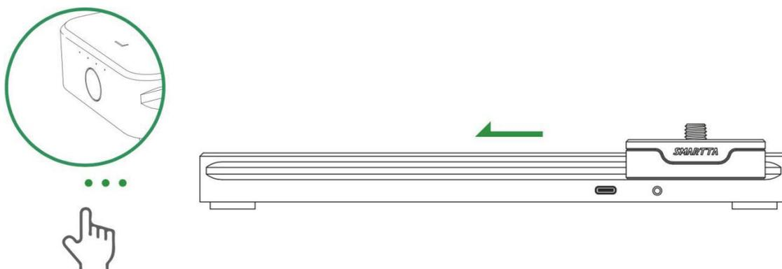
4. 四击电源键，控制滑块以最大速度居中。
