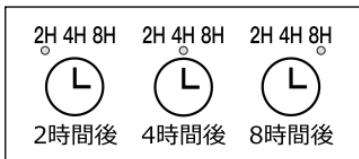
**連続運転モード**：タイマーを設定していない場合、手動で電源をオフにしないと、加湿器が動作し続ける。全てのタイマーアインジケーターが消灯することは、連続動作モードであることを示している。
