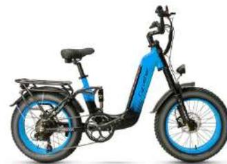
Motorisation 250W Version homologuée voie publique , assistance jusqu'à 25km/h. Motorisation 750W -> Version non homologuée réservée à un usage sur terrain privé hors voie publique, assistance jusqu'à 45km/h. Garantie : 2 ans pour le vélo et 1 an pour la batterie. Vous trouverez dans le carton une boîte à outil pour l'assemblage du vélo et un numéro d'identification unique à accoler au cadre du vélo.
