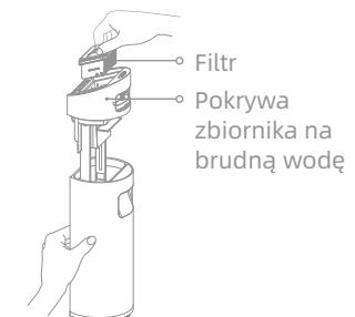
3. Wyptukaj zbiornik na brudną wodę i pokrywę zbiornika czystą wodą. Wyczyść wewnętrzną ściankę zbiornika za pomocą dołączonej szczotki czyszczącej.
