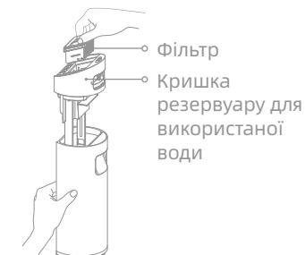
3. Промийте резервуар для води та кришку резервуару водою. Для очищення внутрішньої стінки резервуара можна використовувати щітку, що додається.
