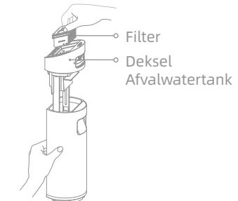
3. Spoel de Afvalwatertank en het tankdeksel met schoon water. Reinig de tank met de bijgeleverde reinigingsborstel.
