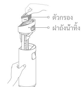
3. ล้างถังน้ำทิ้งบับฝาถังด้วยน้ำ ใช้แปรงทำความสะอาดที่ให้ไปทำความสะอาดผนังด้านในของถัง
