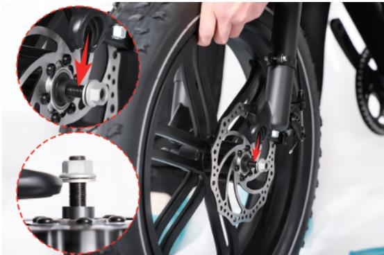
**Schritt 4:** Ziehen Sie die Schrauben auf beiden Seiten der Achse mit einem 15-mm-Schlüssel fest und montieren Sie die beiden Flügelmuttern, indem Sie sie fest andrücken.
