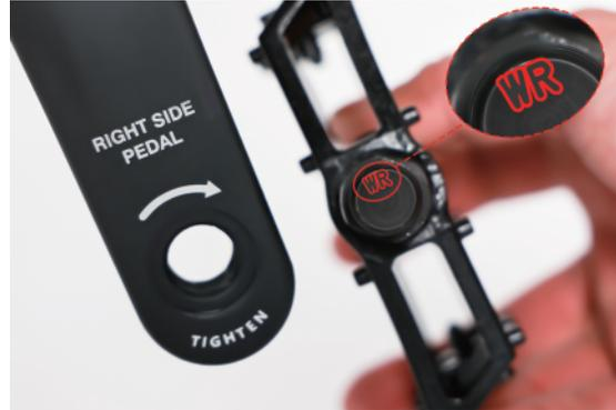
Bevor Sie die Pedale einbauen, tragen Sie eine kleine Menge wasserfestes Fett auf die Achse auf. Fangen Sie dann an, das Pedal mit der Hand einzufädeln, um sicherzustellen, dass das Pedal gerade und in der Richtung des Zeigers auf der Kurbel läuft. Wenn es sich nicht gleichmäßig dreht, vergewissern Sie sich, dass Sie das richtige Pedal – das linke oder das rechte – betätigen. Ziehen Sie die Pedale nach dem anfänglichen Festziehen von Hand anschließend mit einem Standard-15-mm-Schlüssel fest.
