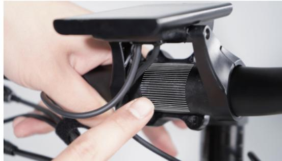
**Schritt 3:** Ziehen Sie die Schrauben am Lenkervorbau fest. Ziehen Sie sie jedoch nicht ganz fest, da Sie den Winkel später eventuell noch genauer ausrichten möchten. Nachdem Sie die beste Position bestimmt haben, ziehen Sie alle Schrauben am Vorbau vollständig an.
