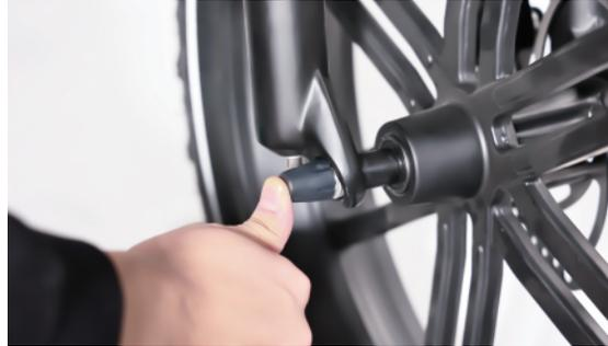
**Schritt 5:** Prüfen Sie die Reifen und stellen Sie sicher, dass der Reifendruck für Fahrkomfort und Sicherheit ausreicht und den auf der Reifenflanke angegebenen Wert nicht überschreitet.
