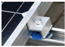
Verwenden Sie die mitgelieferten Klemmen, um die Paneele auf der gesamten Halterung zu befestigen, die Doppelkopf-Mittelklemme, um sie in der Mitte von zwei Paneelen zu platzieren, die einseitige Klammer, um die Seite eines Paneels zu befestigen. Verwenden Sie den Sechskantschraubendreher, um sie festzuziehen
