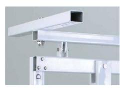
Verwenden Sie M10\*100-Schrauben, um die Stangen E-1, E-2 an der C-Stange zu befestigen
