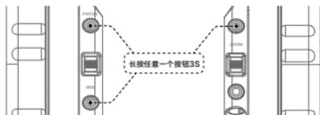
**方法2：**长按马达底部的Channel按钮三秒，直到马达转动时松开，马达将会自动校准镜头行程。使用多通道时，需要逐个马达操作。
