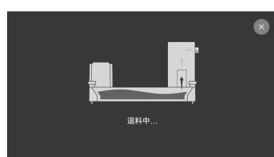
3. 打印失败时，料盒中可能有部分固化的树脂。可以使用料盒清理功能，避免离型膜和固化屏损坏。
