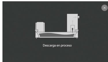
3. Cuando la impresión falla, la resina puede curarse parcialmente en el depósito. Por favor, active la limpieza de la cuba y elimina los residuos. De lo contrario, podría dañar la película de liberación o la pantalla LCD.
