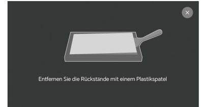
Entfernen Sie die Harzschicht mit einem Kunststoffschaber
