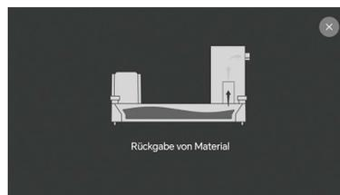
3. Wenn der Druck fehlschlägt, kann das Harz teilweise im Behälter ausgehärtet werden. Bitte stellen Sie auf Wannenreinigung und entfernen Sie die Rückstände. Andernfalls kann es zu Schäden an der Trennfolie oder dem LCD-Bildschirm kommen.
