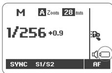
Si la batterie est faible, l'icône clignote sur l'écran LCD. Veuillez remplacer la batterie dès que possible.
