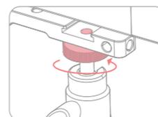
① Ruotare la vite da 1/4 situata sull'adattatore nel foro della vite che si trova sul supporto della luce a LED quindi serrare utilizzando la manopola di fissaggio
