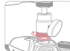
③ Deslice la pieza base de la zapata del adaptador en la zapata de la cámara y apriete la perilla de bloqueo de la base.
