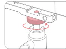
① Tournez la vis 1/4 de l'adaptateur pour l'insérer dans le trou de vis du support de lumière LED et serrez-la en tournant la vis.
