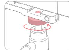
① Gire el tornillo de 1/4 ubicado en el adaptador en el orificio del tornillo que se encuentra en el soporte de la luz LED y apriete con la perilla de fijación.
