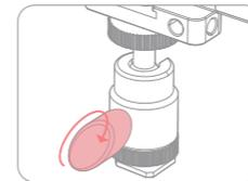
② Ajuste el ángulo del adaptador de cabeza esférica según sea necesario y asegúrelo con el ajustador.
