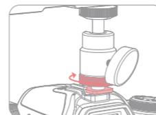
③ Far scorrere la base dell'attacco a slitta dell'adattatore nell'attacco a slitta della fotocamera quindi serrare la manopola di bloccaggio della base.
