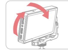
④ Réglez l'angle de la lumière LED grâce au support de montage pivotant.
