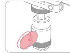
② 必要に応じてボールヘッドアダプターの角度を調整し、角度調整ノブで固定します。
