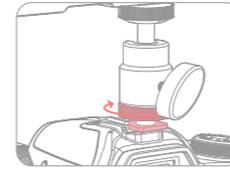
③ Faites glisser la pièce de base de l'adaptateur dans la griffe de l'appareil photo et serrez l'anneau de verrouillage.
