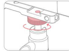
① アダプターにある1/4ネジをLEDライトホルダーのネジ穴に回し、固定ノブで締めます
