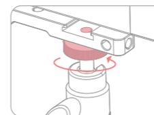
① Drehen Sie die 1/4-Schraube am Adapter in das Schraubenloch am LED-Leuchtenhalter und ziehen Sie sie mit dem Befestigungsknopf fest
