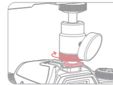
③ Schieben Sie das Blitzschuh-Basisstück des Adapters in den Blitzschuh der Kamera und ziehen Sie den Basis-Verschlussring fest.
