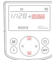
3: Diagrama: 0EV→+0.3EV→+0.7EV 0EV→-0.3EV→-0.7EV. Presione el botón "Λ" o "∨" para ajustar el valor de potencia.
