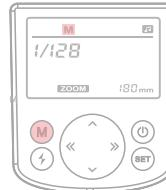
1: Drücken Sie die „M“-Modustaste, bis „M“ oben auf dem Bildschirm angezeigt wird.
