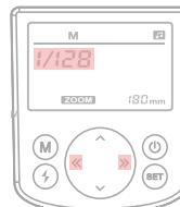
2: Diagramm: 1/1 → ... → 1/32 → 1/64 → 1/128. Durch Drücken der Taste „<“ oder „>“ wird der Leistungswert erhöht/verringert.
