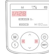
2: Diagramm: 1/1 → ... → 1/32 → 1/64 → 1/128. Drücken Sie die Tasten „<<“ oder „>>“ und der Leistungswert wird abwechselnd erhöht/verringert.
