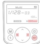
2: 画面に「...」が点滅するまで「SET」ボタンを押して、設定を微調整します。
