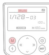
1: Drücken Sie die „M“-Modustaste, bis „Multi“ oben auf dem Bildschirm angezeigt wird.
