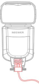
⚠ Para suministrar energía al condensador flash, compre la fuente de alimentación flash (no incluida) por separado. Al usar la fuente de alimentación, también se deben insertar baterías AA en el compartimiento de la batería.
