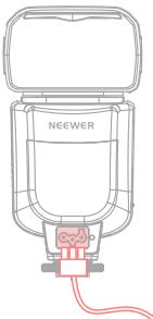
如需给闪光灯电容供电,请自行购买闪光灯电源盒(不包含的)。使用时确保AA电池也装在电池仓内。
