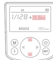
3: Schema: 0EV→+0.3EV→+0.7EV0EV→-0.3EV→-0.7EV. Druk op de "Λ" of "V"-knop om de vermogenswaarde te verfijnen.
