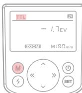
1: Drücken Sie die Modustaste „M“, bis „TTL“ oben auf dem Bildschirm angezeigt wird.
