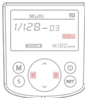
2 : Appuyez sur le bouton "<<" ou ">>" pour régler la fréquence du flash de 01Hz à 199Hz.
