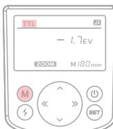
1: Presione el botón de modo "M" hasta que se muestre "TTL" en la parte superior de la pantalla.
