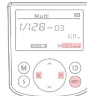
2: Druk op de "SET"-knop totdat een knipperende "--" wordt weergegeven op het scherm zodat u de instellingen kunt verfijnen.
