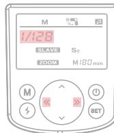
2: Diagramma:  $1/1 \rightarrow \dots \rightarrow 1/32 \rightarrow 1/64 \rightarrow 1/128$ . Premere il pulsante ""<<"" o "">>"" così il valore della potenza aumenterà/diminuirà a sua volta.
