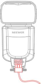
Om de flitscondensator van stroom te voorzien, dient u de flitsvoeding (niet meegeleverd) apart aan te schaffen. Tijdens gebruik van de voeding, moeten de AA-batterijen ook in het batterijvak worden geplaatst.
