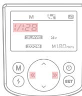
2: Diagramm: 1/1 → ... → 1/32 → 1/64 → 1/128. Drücken Sie die Taste "<<" oder ">>" und der Leistungswert wird der Reihe nach erhöht/verringert.
