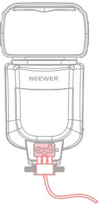
Per alimentare il condensatore del flash, acquistare separatamente l'alimentatore del flash (non incluso). Quando si utilizza l'alimentatore, sara' necessario inserire anche le batterie AA nel vano batterie.
