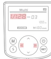
2: Pulse el botón "<<" o ">>" para configurar la frecuencia del flash: 1/128→1/64→1/32→...→1/4.
