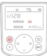
1: Drücken Sie die Modustaste „M“, bis „S2“ auf dem Bildschirm angezeigt wird.
