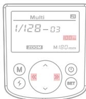
2: Presione el botón "<<" o ">>" para configurar la frecuencia del flash de 01 Hz a 199 Hz.
