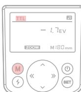
1: スクリーンに「TTL」が表示されるまで「M」モードボタンを押します。
