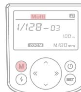
1: Presione el botón de modo "M" hasta que se muestre "Multi" en la parte superior de la pantalla.
