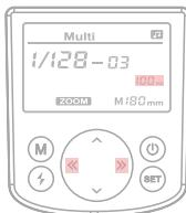
2: Premere il pulsante "<<" o ">>" per impostare la frequenza del flash da 01Hz a 199Hz.
