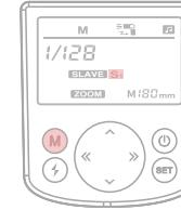
1: Drücken Sie die Modustaste „M“, bis „S1“ auf dem Bildschirm angezeigt wird.
