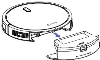
3. Instale el tanque de agua en el robot.
