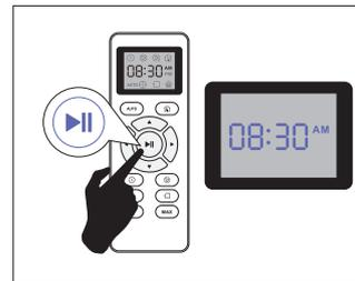
Y entonces presione el
