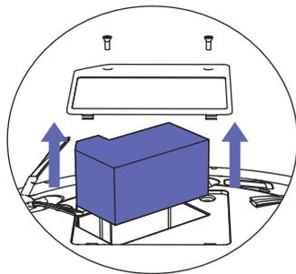
2. Desatornille los dos tornillos en el compartimento de la batería, entonces retírela.
