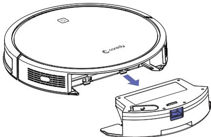
**2.** Remueva el trapeador del tanque de agua, lávelo y déjelo secando.
