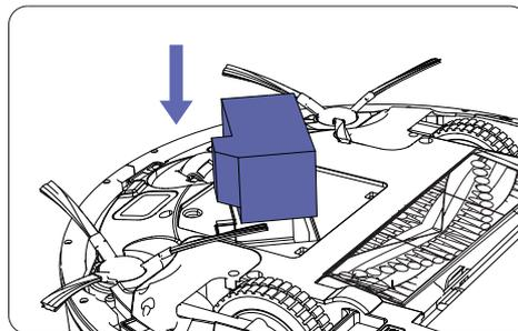
3. Reinstale el compartimento de la batería y los dos tornillos. Tenga cuidado de no pellizcar el cepillo lateral con el compartimento de la batería cuando la reinstale.
