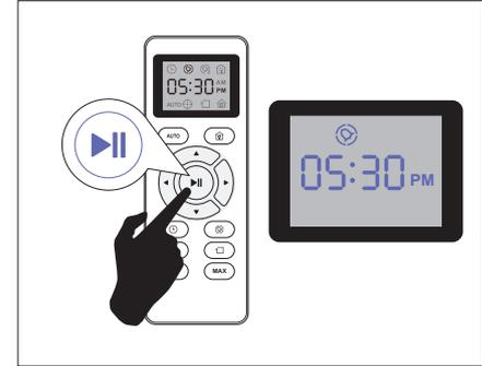
Y entonces presione el
