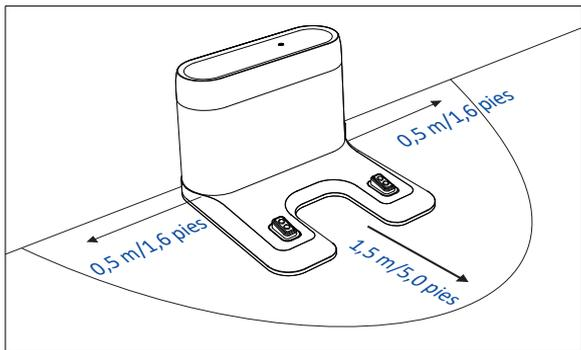
6. Enchufe el cable de alimentación en la base de carga, luego conecte el adaptador a un tomacorriente de pared, el indicador LED en la base de carga es de color verde fijo.
