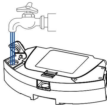
2) Moje el trapo y escúrralo hasta que no goteo, coloque el paño de limpieza en el módulo de limpieza.
