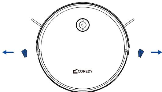
2. Instale los cepillos laterales en la parte inferior de Coredy Robot aspirador presionando un cepillo en cada ranura hasta haga clic.
