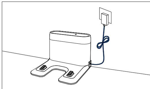
7. Coloque el robot en la base de carga alineando los contactos metálicos de carga.
