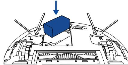
3) Vuelva a instalar la puerta de la batería y los tornillos. Tenga cuidado de no pellizque los cepillos laterales en la tapa de la batería cuando vuelva a instalarlos. cargando la batería.
