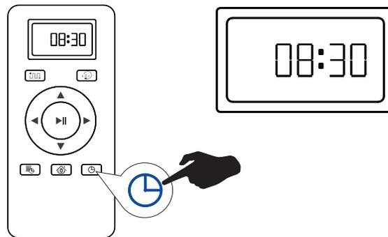
Y luego presione el botón
