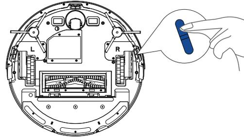
2) Limpie las clavijas de contacto de carga del robot y el Base de carga con un paño limpio y seco.
