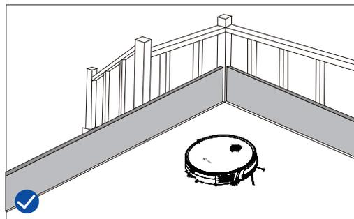
Si la habitación a limpiar contiene un balcón, se debe usar una barrera física para evitar el acceso a la balcón y garantizar un funcionamiento seguro.
