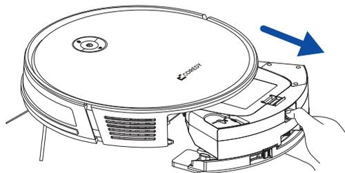
2) Abra y vacíe el depósito de polvo, vacíe el agua restante del tanque de agua si tiene.
