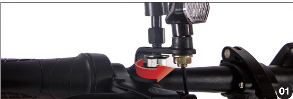
▶ 専用工具でネジを矢印の方向に回し、バックミラーをしっかりと固定させます
