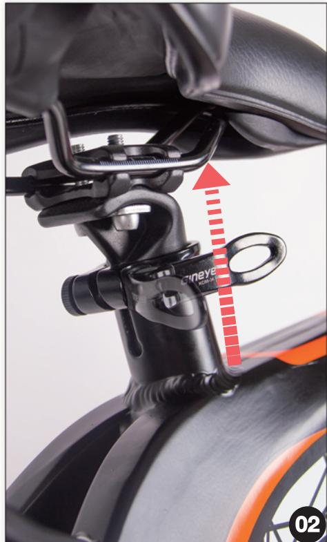
▶ クイックレバーを緩め、ポストの高さを調整します。調整後、クイックレバーでしっかりと固定します。
