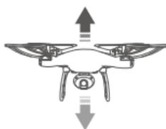
Poussez le Joystick Gauche vers l'avant, le drone montera; poussez-la vers l'arrière, il descendra.
