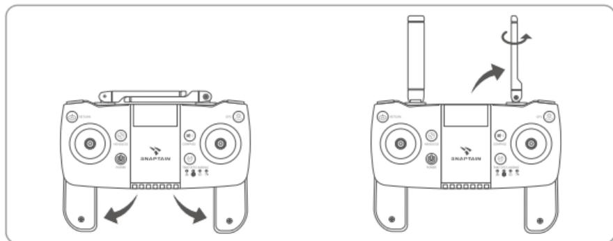
7. Aprire il morsetto per telefono e montare il dispositivo mobile.
