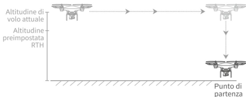
Premere di nuovo il pulsante
