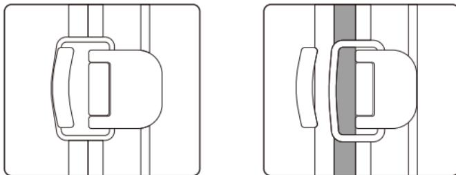
Zwischen den beiden Verriegelungsbügeln ist eine Befestigung für ein Vorhangeschloss vorgesehen. So kann die Kamera sicher gegen unbefugtes Öffnen verriegelt werden.
