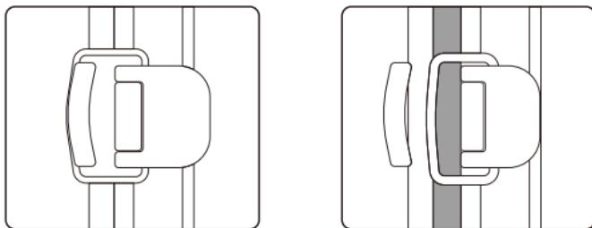
Une fixation pour un cadenas est prévue entre les deux pattes de verrouillage, permettant à la caméra d'être bien verrouillée.
