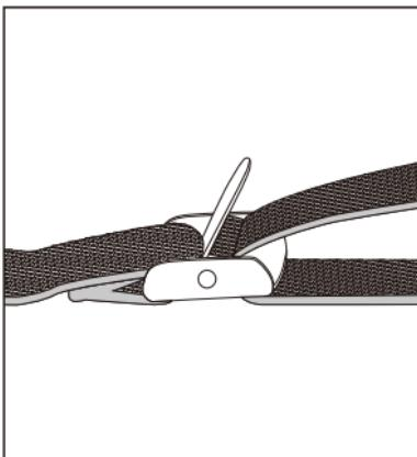
Führen Sie den Sicherungsgurt durch beide Schlaufen der Kamera, positionieren Sie Ihre Kamera, führen Sie das Gurtende durch das Gurtschloss und ziehen Sie den Gurt stramm. Zum lösen öffnen Sie die Lasche und ziehen den Gurt heraus.
