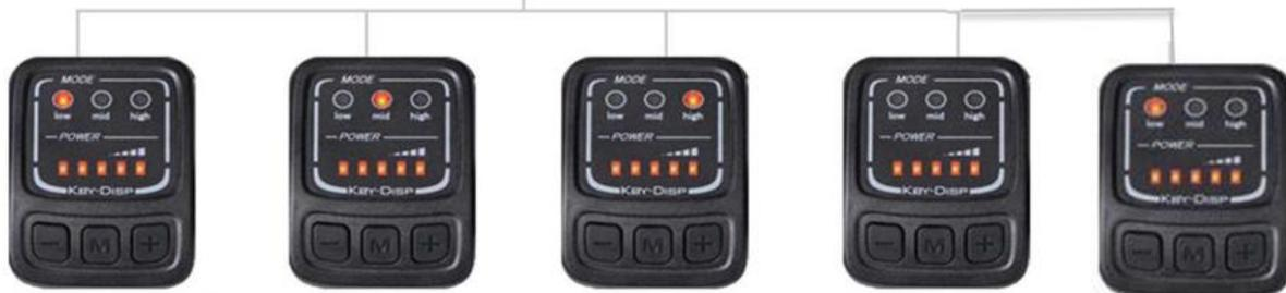
3.2.1: Mantenga pulsado el botón durante 2 segundos para encender / apagar el sistema E-Bike. El valor predeterminado es el nivel de asistencia al pedal "bajo". Función eléctrica completa (modo eléctrico puro)
