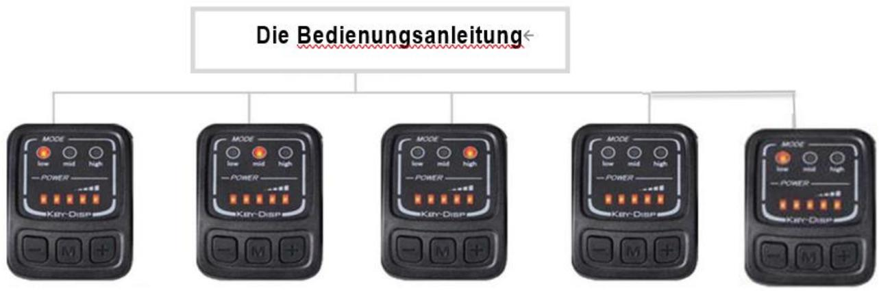
3.2.1: Halten Sie die Taste 2s lang gedrückt, um das E-Bike-System ein-/auszuschalten. Der Standardwert ist „niedrige“ Tretunterstützung. Vollelektrische Funktion (reiner Elektromodus)
