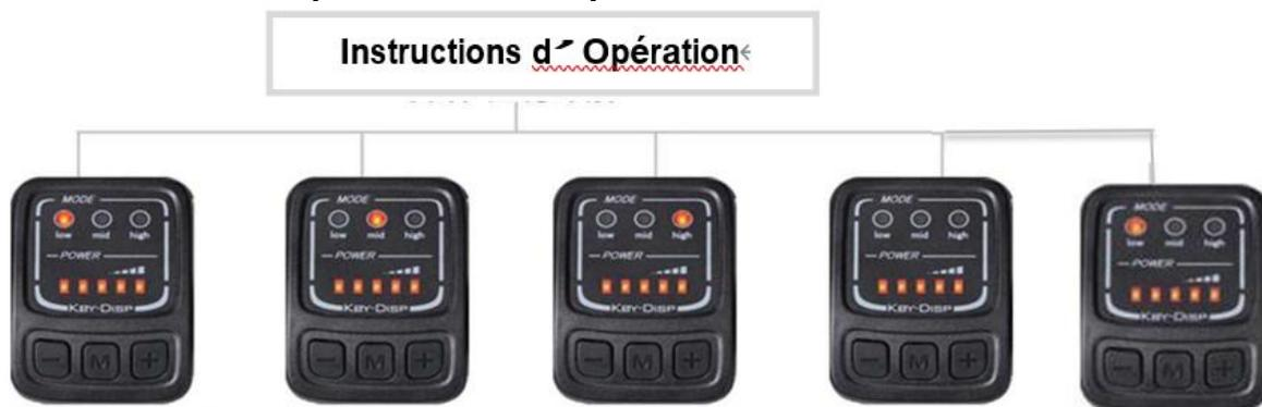
3.2.1 : Maintenez le bouton enfoncé pendant 2 secondes pour allumer/éteindre le système E-Bike. La valeur par défaut est le niveau d'assistance à la pédale « faible ». Fonction électrique complète (mode électrique pur)
