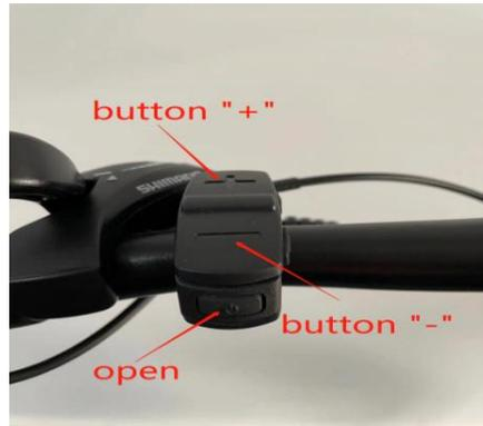
**3.2. Funktionale Layout-Oberfläche des Displays** (Weitere Informationen erhalten Sie von uns, um die Bedienungsanleitung für das Display zu erhalten.)
