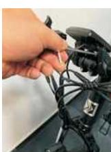
5.1 Revisa los dos pedales. El pie con una "L" impresa en el extremo del eje central debe instalarse en el lado izquierdo del vehículo (sin disco dentado) y girar en sentido antihorario. El pie con "R" se instala en el lado derecho (con disco dentado) y gira en el sentido de las agujas del reloj, luego usa la llave No.15 Apriete el eje del núcleo del pie (preste atención a atornillar el pie primero con la mano y luego bloquearlo con un llave inglesa).
